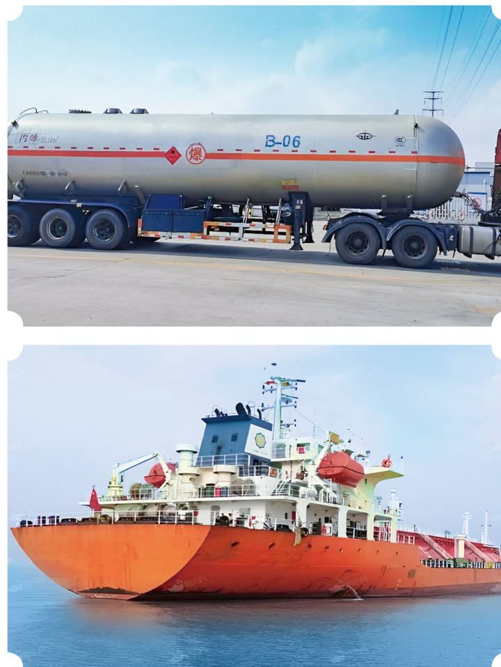
图 1-22 丙烯压力槽车与船
